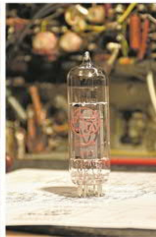
Röhrenradios wie dieses können in der Regel wieder funktionstüchtig gemacht werden. In den meisten Fällen muss nur die sogenannte Röhre ausgetauscht werden, damit das Radio wieder funktionstüchtig ist.
